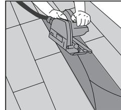
Um die Diele aus dem Verbund auszutauschen, müssen Sie die Diele wie auf der Abbildung mit einer Handkreissäge einschneiden. Stellen Sie hierzu die Schnitttiefe exakt auf die Dicke der Diele ein. Falls die Feuchtesperre durch die Säge beschädigt wurde, setzen Sie ein neues Stück Folie ein.
