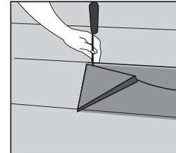
Entfernen Sie die Eckstücke mit einem Stechbeitel.
