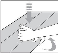
Falls Sie den Boden entfernen möchten, heben Sie die Dielen einigem Zentimeter nach oben an und klopfen Sie an der Verbundleiste entlang.
