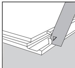
Entfernen Sie die Erhöhung an der Vorderkante der Nutseite der neuen Diele.
